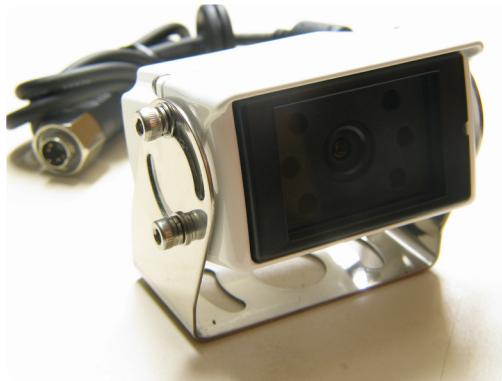
La **caméra couleur HD** avec le CCD Sony Super HAD est totalement **étanche au nettoyage haute pression**, certifiée **IP69K**. Le CMT 77-HD offre **résistance aux vibrations** jusqu'à **30G**, possède un **chauffage intégré**, un **microphone étanche**, **LED infrarouge** et **support de fixation en acier INOX**!
